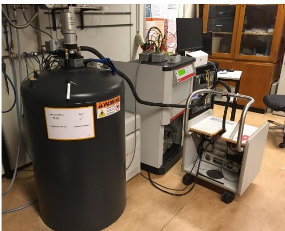
Abb2.: Tieftemperatur-Messplatz, an dem mithilfe von flüssigem Helium elektrische Eigenschaften zwischen 350K und 2K vermessen werden können.
